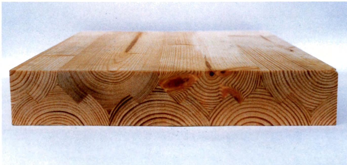
Foto 1. Lock-Wood limtræplade fra Finland, lavet af råtræ med en diameter på ca. 10 cm i toppen. Endefladerne er oliebehandlet for at fremhæve årene.
