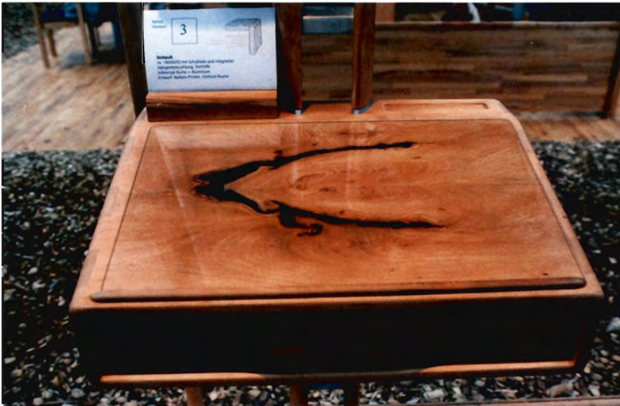
Foto 7. Skrivepult hvor der er en alvorlig fejl i bordpladen (som er dækket af en glasplade).
