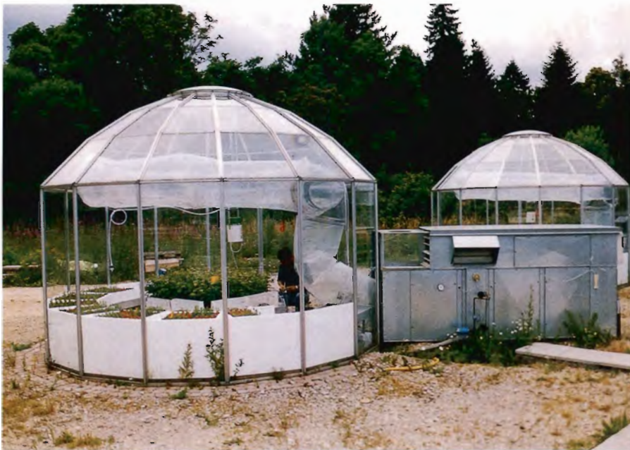
Foto 1. Otte 60 m 3 klimaregulerede eksponeringskamre ved Landbohøjskolens Arboret blev anvendt til at undersøge ændringer i vækst og fysiologi hos rødgran og bøg ved ændrede temperaturer og øget indhold af kuldiioxid i atmosfæren. Foto: H. Saxe.
