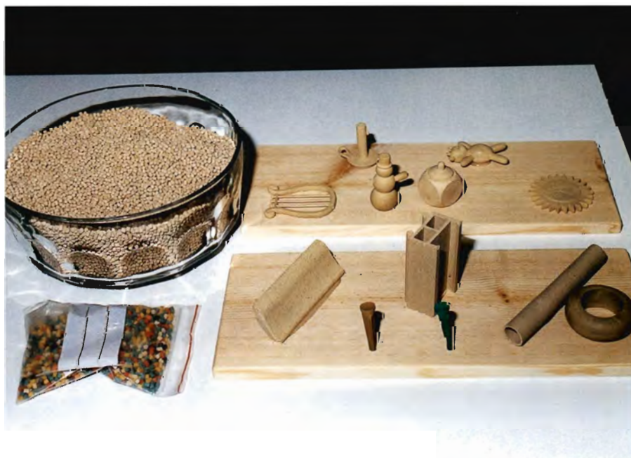
Foto 5. Formsprøjtning af træ. Til venstre piller som er råvaren, til højre forskellige produkter.
