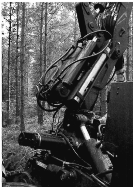
Den patenterede hjælpecylinder med akkumulator som nedsætter energiforbruget drastisk. Foto: Lars Davner, Skagen.
