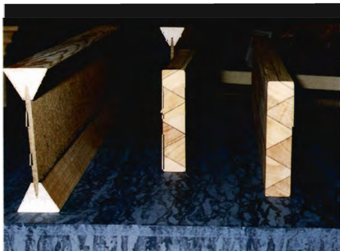
Foto 1. Limtræsbjælke lavet af trekantede træstykker.
