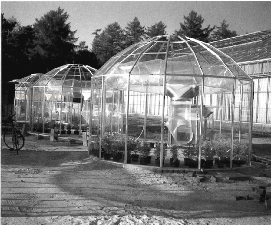
Figur 3. Landbohøjskolens temperaturstyrede kamre med recirkulering af luft til brug ved undersøgelser af skovtræers reaktioner på ozon og kuldioxid.
