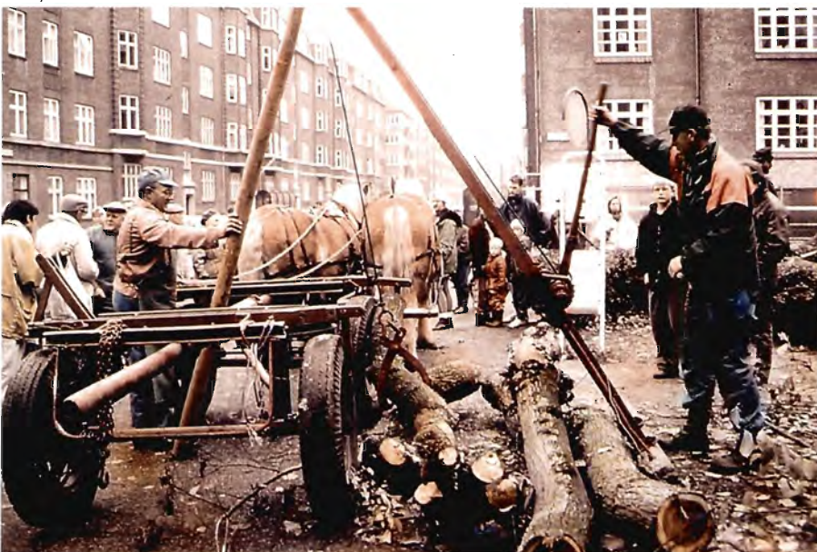
Foto 6. Et par grene hejses med et spil op på den medbragte skovvogn med hesteforspand.
