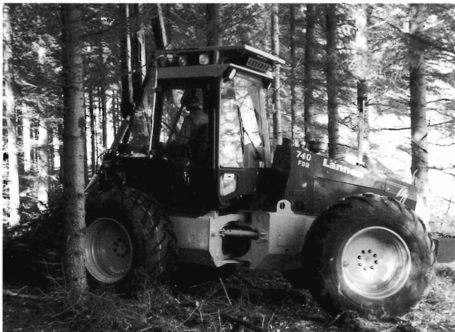
Basismaskinen er knækstyret - dvs. for- og bagende kan drejes i forhold til hinanden - og derved er den let at manøvrere.
