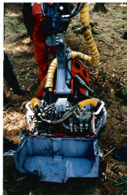
Ved at åbne den grå kasse på skovningsaggregatet er det nemt at komme til hydraulikken.
