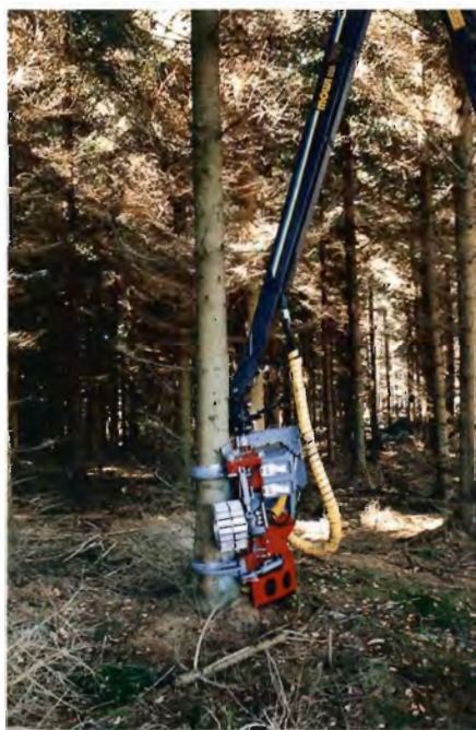
Fældediameteren i rodsnittet er 49 cm, og knivenes stammeomslutning er 33 cm. I praksis er den bedst egnet til de første tre tyndinger - op til en brysthøjdediameter på godt 20 cm.
