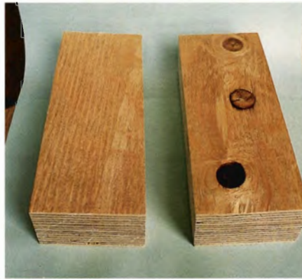
Nærbillede af to stykker LVL træ. Som det fremgår accepteres knaster.
