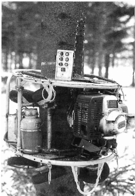
En radiostyret klatresav af mærket KS 31F til opkvistning af nåletræer. Pris: 13200 SFR, ca 60.000 kr.
