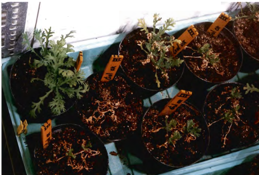
Afprøvning af UV-lys til bekæmpelse af ukrudt, her gul okseøj. Planten øverst til venstre er ubehandlet, de øvrige har fået UV-lys i en periode fra 1 til 9 sekunder ved en intensitet på 2,5 kW/m 2 . De behandlede planter viser forskellige grader af nedvisning. Det bemærkes at gul okseøj er en af de mere sejlivede planter ved UV-behandling.
