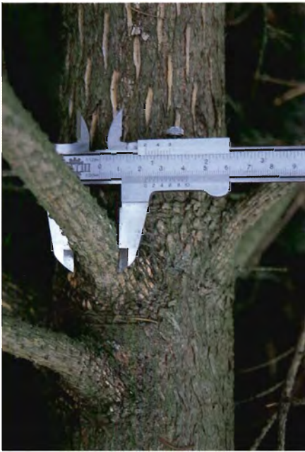
Foto 1. Diameteren af en tømmerstoks tykkeste gren i den grenkrans, som er nærmest 5 m over jorden, er en god indikator for tømmerkvaliteten. En gren tykkelse på 20 mm under bark er skillelinje mellem klasse B og klasse C tømmer. For sitkagran svarer en horisontal grendiameter på 20 mm til 22-23 mm over bark. (Fot. JPS, maj 1997).
