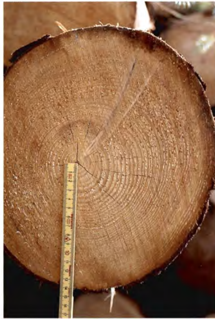
Foto 3. Åringsbredden hænger godt sammen med egenskaber, som er af betydning for træindustriens kunder. Ifølge Trænormens krav til konstruktionstræ i bedste kvalitetsklasse må den gennemsnitlige årringsbredde ikke overstige 4.5 mm i topenden af en tømmerstok. (Fot. FR, maj 1997).
