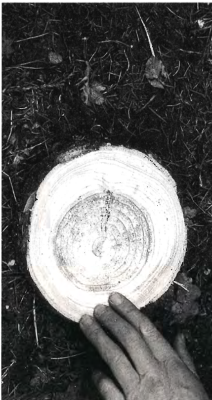
Rødgran på 15 cm i brysthøjde. Hvis træet er sundt skal målingen vise højst 75 mikrosekunder, og hvis der er råd over 112. På dette træ blev resultatet 108 hhv. 113 i to på hinanden vinkelrette målinger, og efter fældning viste det sig at der var råd i omkring halvdelen af træets diameter.
