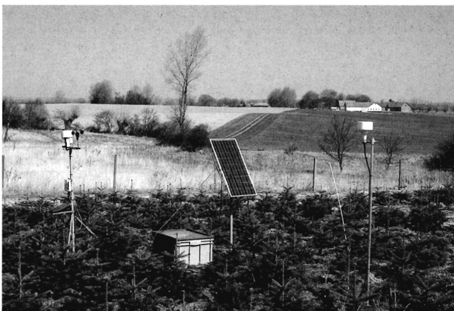
Billed 1. Jordvæsken opsamles automatisk af et solenergidrevet jordvandssondesystem. Til stationen er også knyttet en automatisk meteorologisk målestation, hvor temperaturen i luften og på nåleoverfladerne måles kontinuerligt. Endelig er der monteret udstyr (TDR-prober) til manuel måling af jordens indhold af vand. I nær fremtid opstilles trakte, der indsamler de stofmængder, der tilføres fra atmosfæren sammen med regn, partikler og gasser.
