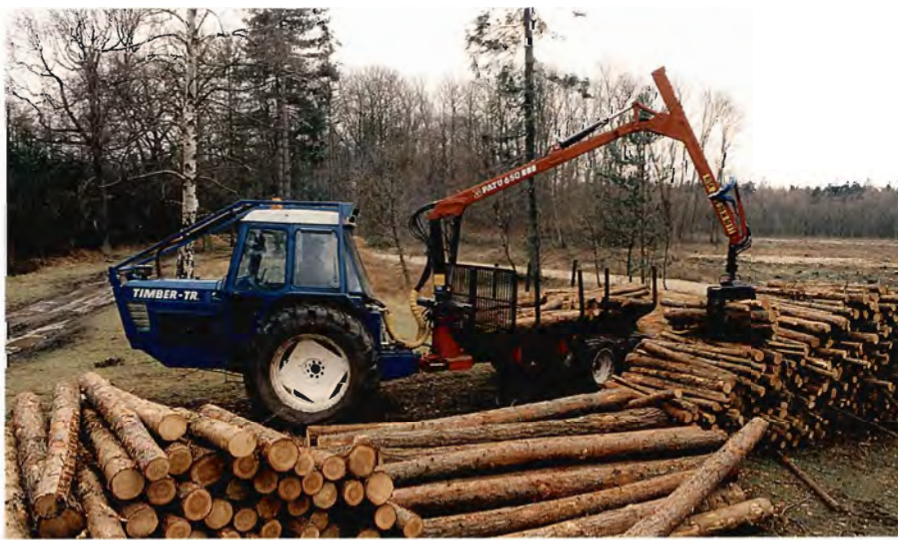
Fig. 3. Caledonian Forestry Services udkørselsmaskine bestående af en Ford traktor og en Patu kranvogn. Maskinen minder i udseende meget om den svenske "Snorre".
