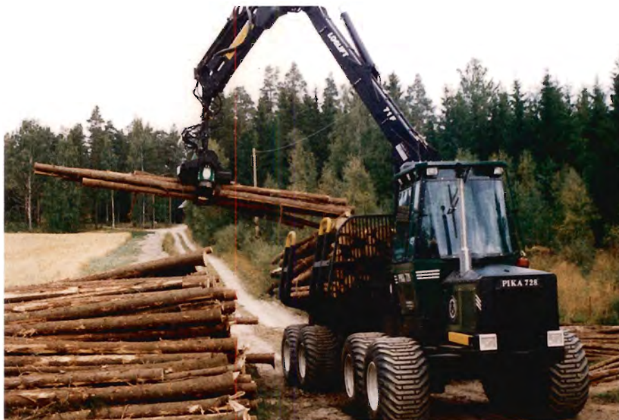
En "drivare" kan klare både skovning og udkørsel. Her Pika 300 på udkørselstraktoren Pika 728T, en finsk maskine. (Foto: Pinomäki OY).
