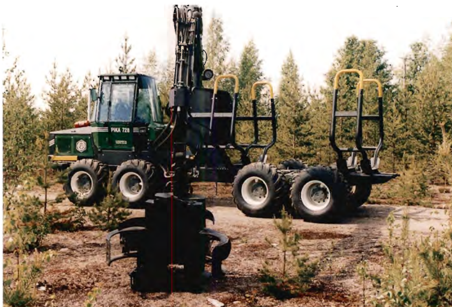
En "drivare" kan klare både skovning og udkørsel. Her Pika 300 på udkørselstraktoren Pika 728T, en finsk maskine. (Foto: Pinomäki OY).
