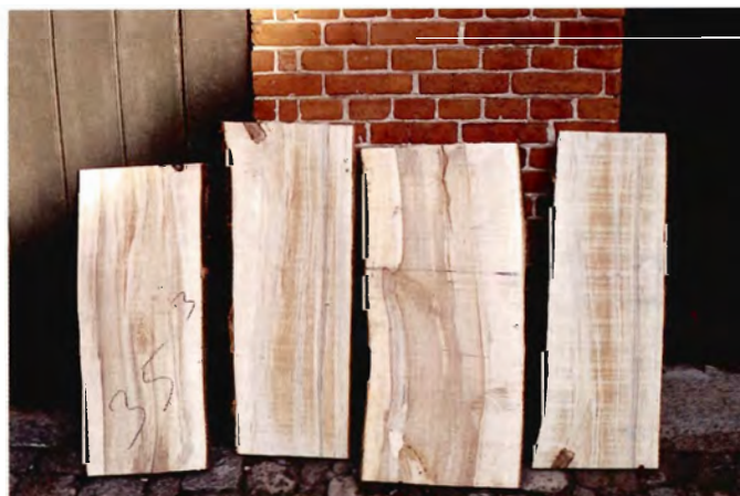
Figur 8. Misfarvninger i tørkeskadede bøgeplanker. (Foto: BBJ, 12. sep. 1995).
