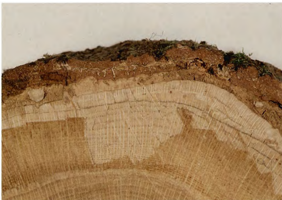
Fig. 9. Del af snit gennem 80-årig eg i fældehøjde. Kun en smal del af den indre bark var levende. Den ydre bark var død og gennemvokset af honningsvamp (de hvide striber). Skaden grænser op til større barkparti dræbt i vinteren 86/87. Foto J. Koch.
