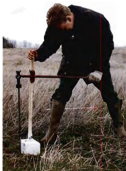
Figur 4a. Boret er slået i jorden og hæves nu v.h.a. en løftestang, der er monteret på hammerskaffet. Der benyttes to bor på hhv. 1 og 2 meter.
