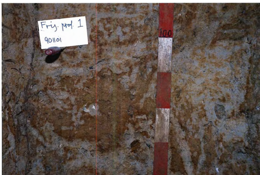
Foto 1. Jordprofil med tydelig pseudogley (de grå/røde marmoreringer). Disse pletter indikerer, at der er problemer med vandstuvning på lokaliteten.
