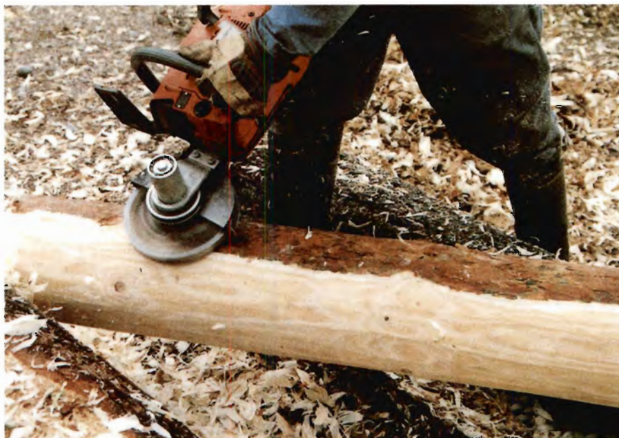
Med Barkar-Kalle kan man afbarke og tildanne tømmerstokke til fx tømmerhuse.
