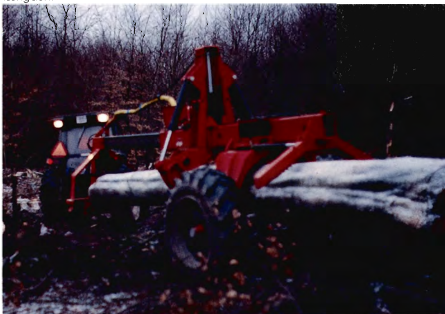
Figur 3. Skov- og Naturstyrelsen har udviklet en fuldhdraulisk kævlevogn. Vognen muliggør en skånsom udtransport af løvtrækævler på 1,3 m i diameter og 12 m i længden.
