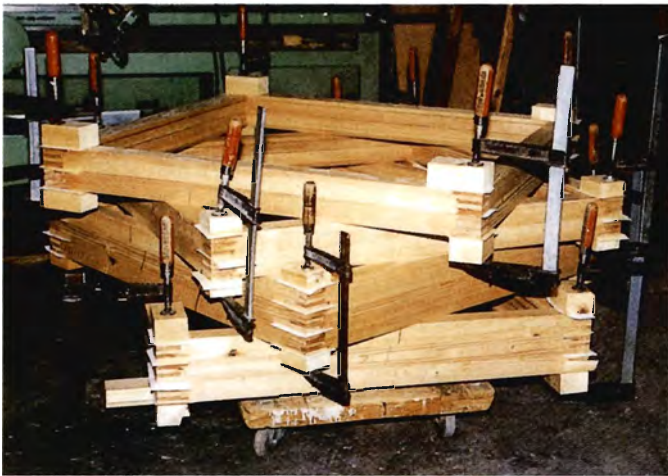
Fremstilling af douglas vinduer. Efter sammenlimning holdes rammehjørnerne sammen med skruetvinger for at undgå brugen af søm, der ved douglas kan bevirke flækning af træet.
