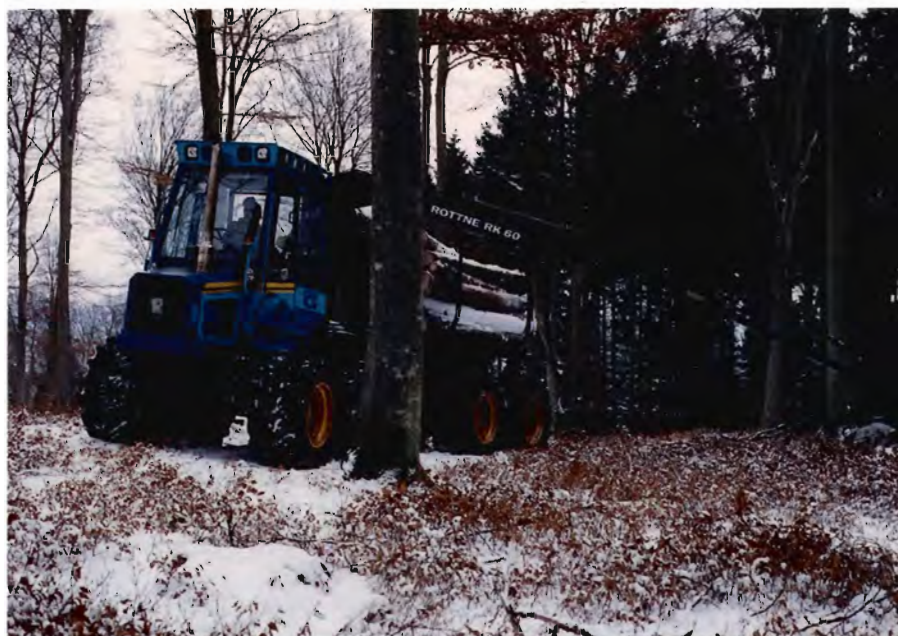
Figur 2. Kørsel i bevoksninger bør koncentreres til kørespor med en indbyrdes afstand på ca. 15 m. Herfra kan udkørselstraktorerne nå effekterne med en kranrækkevidde på ca. 8 m.
