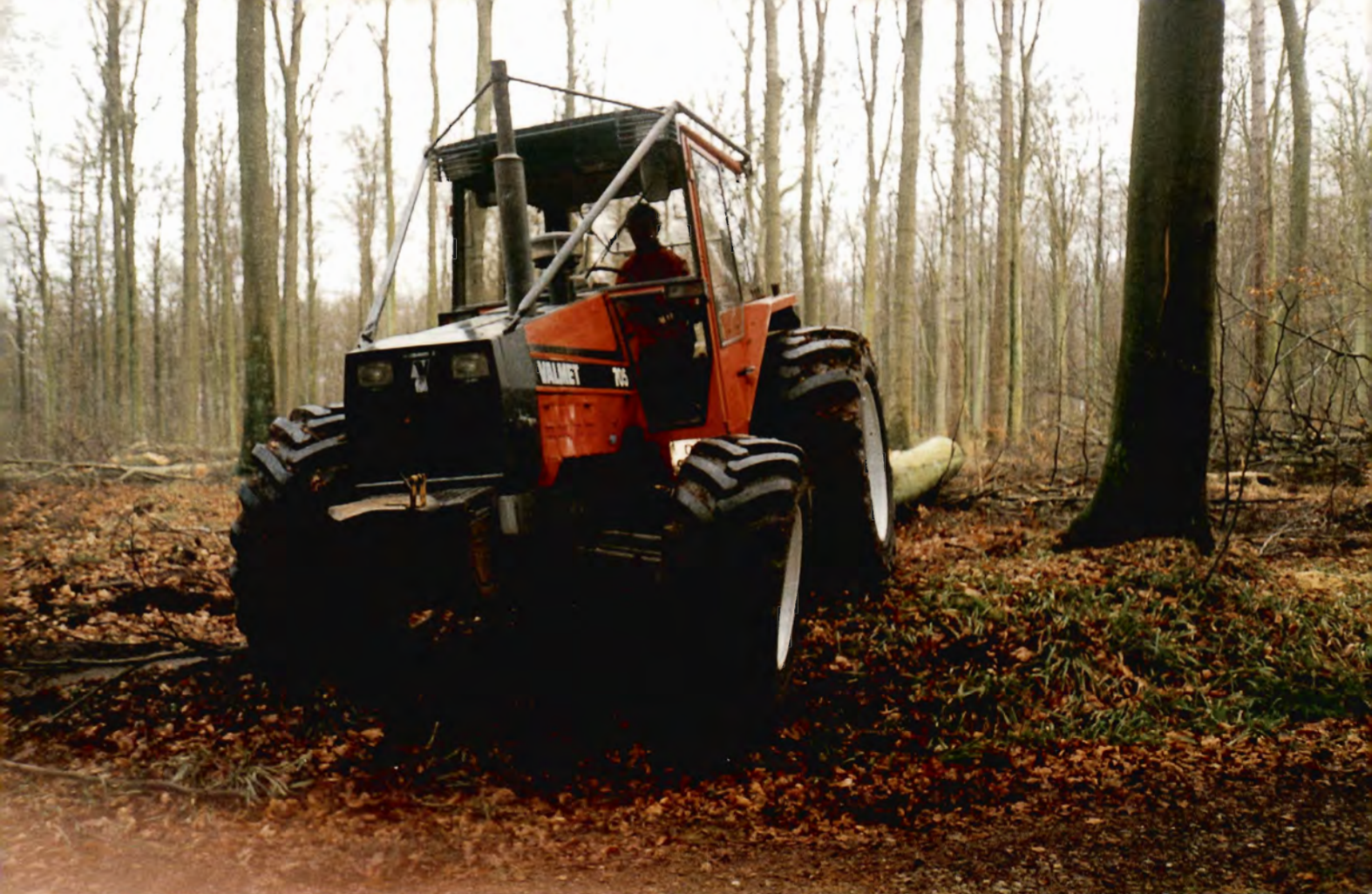
Figur 1. En udslæbningstraktor med brede lavprofildæk har et middel marktryk på ca. 0,3 \text{ kg/cm}^2 i ubelæsset tilstand. Dette svarer til marktrykket for en gående voksen person.
