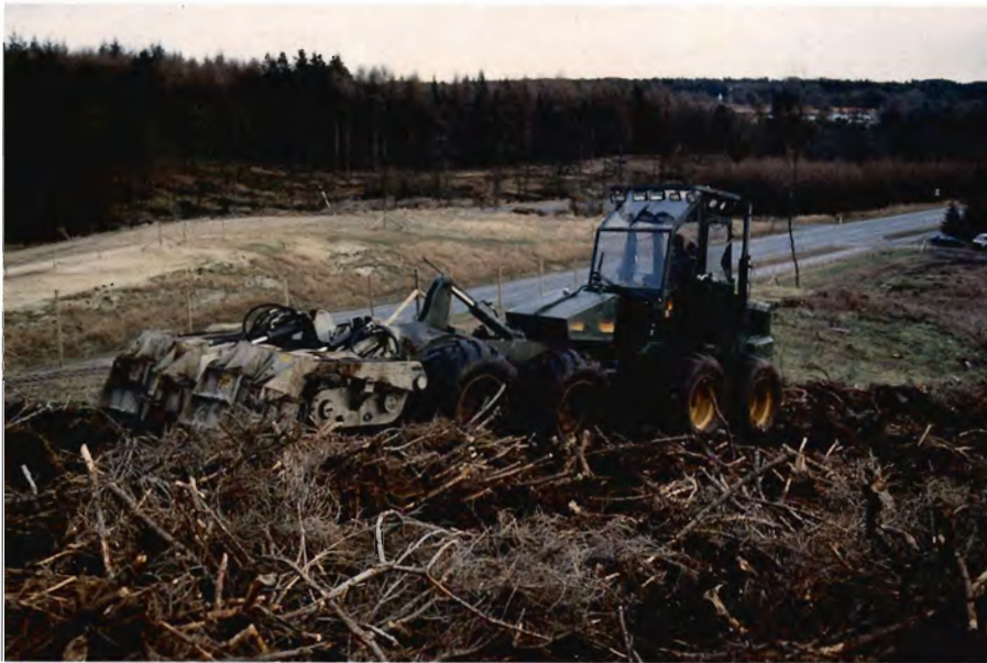
Multigrubberens montering på en 8-hjulet basismaskine har den fordel at den er meget terrængående og giver færre bevægelser i chassiset - til glæde for maskinføreren.
