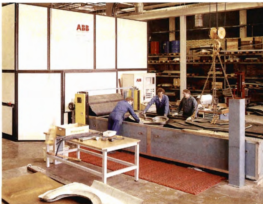
Træet presses sammen i en såkaldt Quintus-presse fra ABB, som har været anvendt i fly- og bilindustrien i 25 år.
