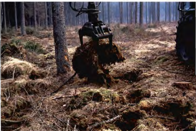
Arbejdet med griberen går bedst, hvis humustørven er græs-bunden.
