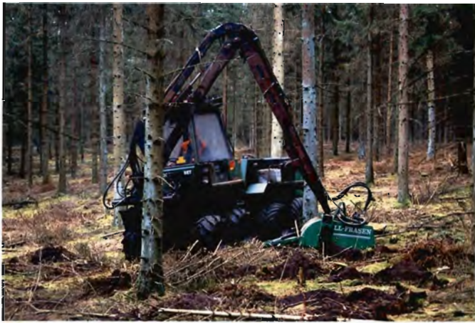
LL-fræseren efterlader en ujævn skovbund, fordi den også lægger en del af mineraljorden op.
