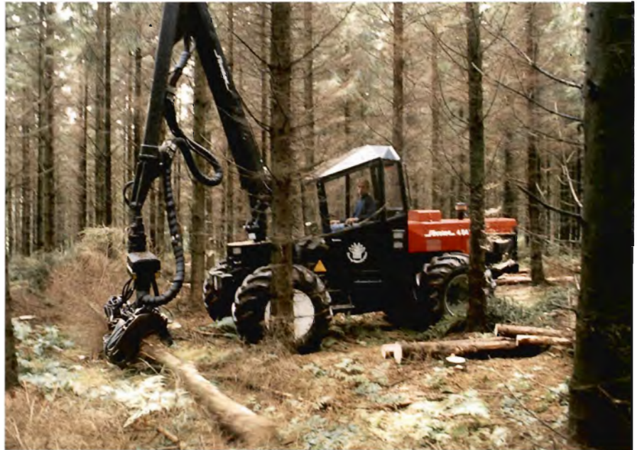
Det er Skov- og Naturstyrelsens mål at udvikle og effektivisere skovdriften. Det sker bl.a. ved en løbende maskinudvikling og ved at oprette regionale maskinstationer for statsskovene. Billedet viser skovningsmaskinen Silvatec 454, foto 1990.
