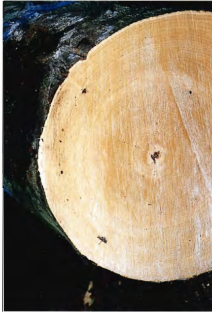
Foto 2. Tværsnit af bøg 50 cm fra skudstedet. Der er ganske små fregner i 9. årring. I midten ses ret små skader fra kernesked (der har ramt direkte), mens strejfskuddene foroven og forneden har givet op til 4 gange kraftigere misfarvning.
