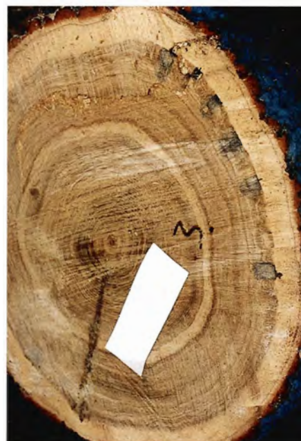
Foto 7. Tværsnit af eg ud for skudstedet. En hel serie „bremsespor“ viser hvordan misfarvningen trænger ind i det ubeskadigede ved.
