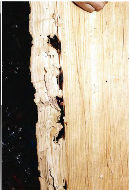
Foto 3. Flækning af bøg ud for skudstedet. De første 2-4 år efter beskydningen har der været en kraftig sårddannelse, som herefter er overvokset. Arringene er op mod en halv gang bredere end det normale ved, og selv 9 år efter beskydningen er veddet ikke „faldet til ro“.
