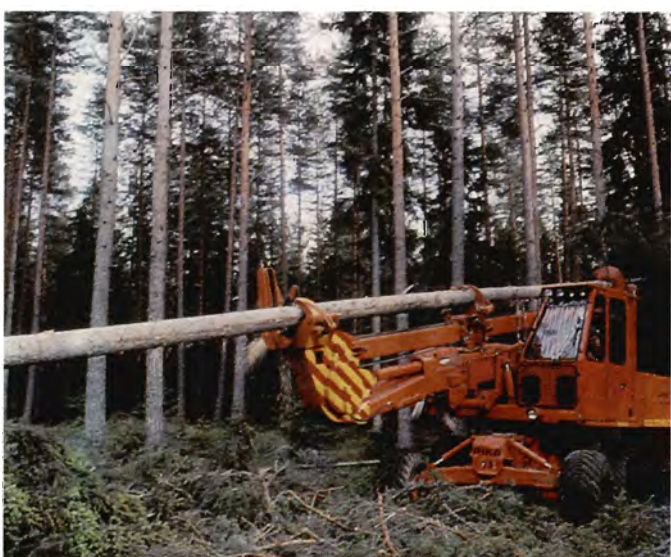
Figur 2: Pika 75 skovningsmaskine. Kvistningsbommen anbringes på stammen som kvistes stående til en højde af 7,5 m - og samtidig skæres stammen over med motorsav (øverst tv.). Herefter vippes træet op og fri af foryngelsen (herover). Forud for afkvistning svinges overdelen til ønsket oparbejdningsposition, således at grenene falder i køresporet og sortermenterne placeres hensigtsmæssigt for udkørsel (tv.).
