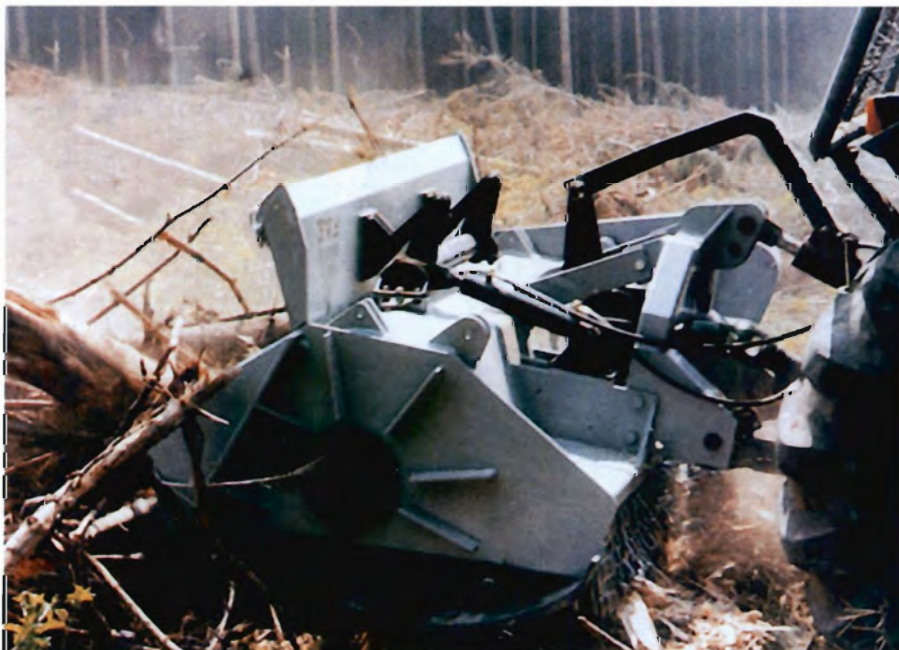
FMH modellen som kan knuse grene med en tykkelse på op til 50 cm.
