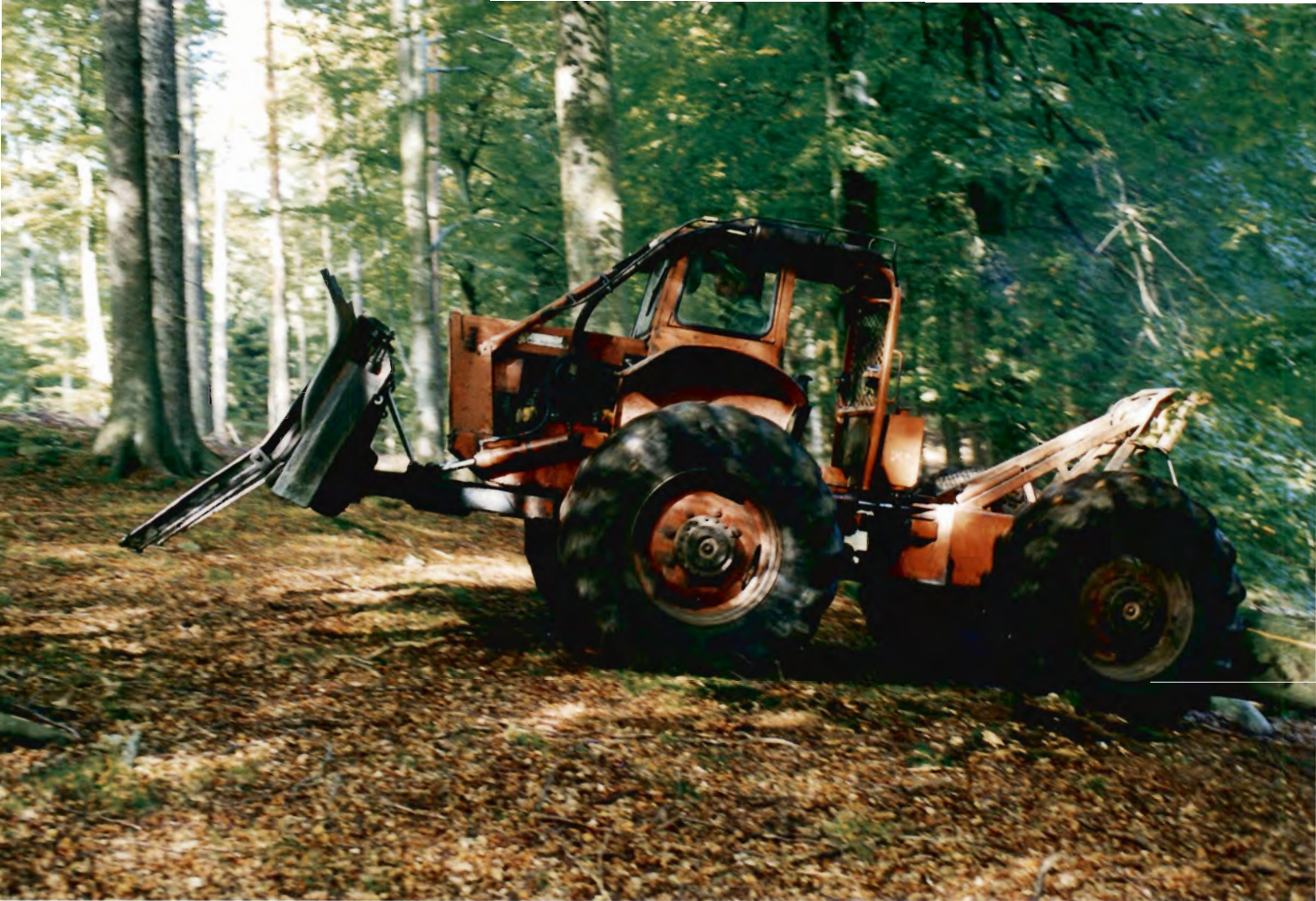
1968: Store bøgekævlere slæbes ud med Tree Farmer, en knækstyret specialtraktor der blev meget anvendt ved oprydning efter stormfaldene.
