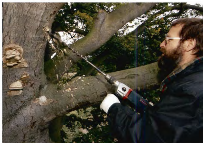
2. Finn Bennicke borer 2/3 gennem stammen. Han laver et eller to sådanne huller til dynamitten, afhængig af stammens tykkelse.
