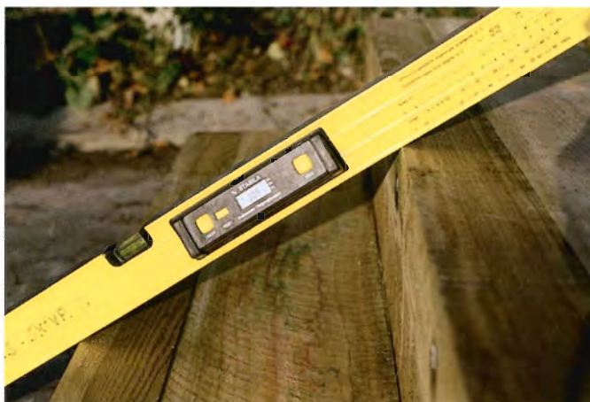
Foto 4. Et kombineret vaterpas og skræntmåler med elektronisk display.
