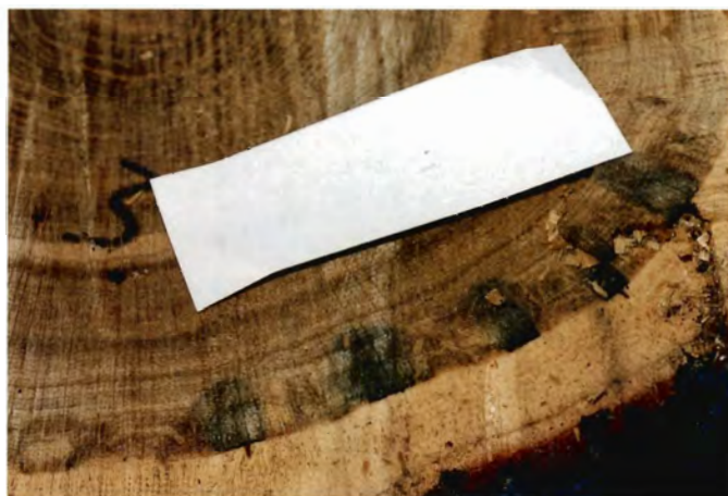
Tværsnit af egekævle der har fået et kernesked med stålhagl. En hel serie "bremsepor" viser hvordan misfarvningen træder ind i det ubeskadigede ved. Foto fra november 1995, DTI-foto.
