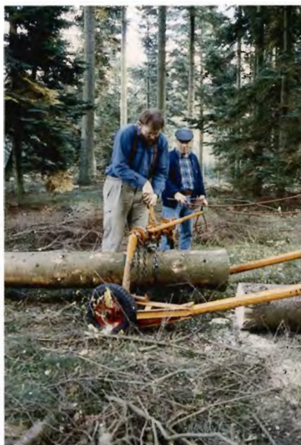
Foto 2. Tømmeret hejses op i Ulvins Kombidrag med en skralde og kommer dermed godt fri af jorden.
