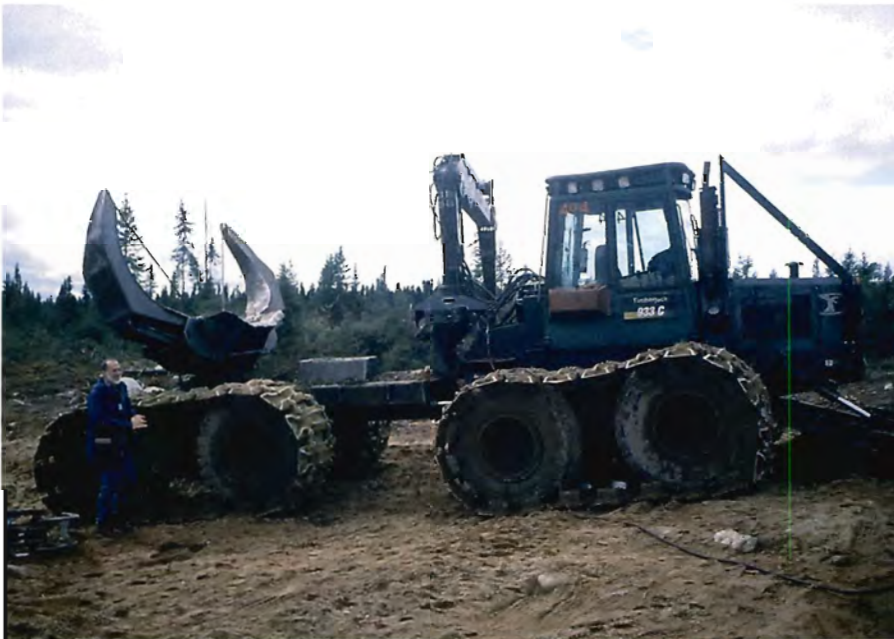
Foto 2. En kæmpestor Timberjack 933C med klembanke, som anvendes til udslæbning af hele træer på renafdrifter i det centrale Canada.
