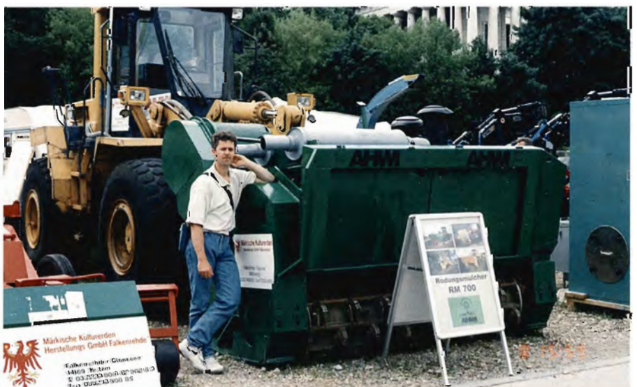
Figur 2. Denne 2,5 m brede knuser med selvstændig motordel kan „flishugge“ 3 stykker 16-20 cm tømmer ad gangen, hvis de tilfældigvis skulle være glemt på arealet efter endt skovningsarbejde. Maskinen blev suppleret af et stort udbud af traditionelle slagleknusere.
