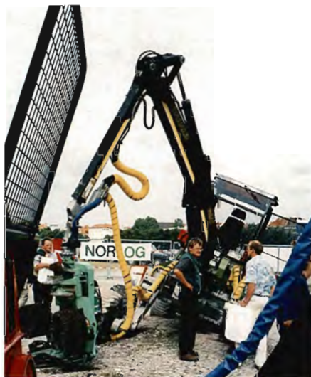
Figur 3. Denne meget terrængående skovningsmaskine vakte stor og berettiget interesse. Dens bevægelighed til siderne og frem og tilbage er imponerende. Beroende på 4 uafhængige bogger hæve/sænkbare over 1/2 meter i begge retninger. Maskinens kapacitet kan formodentlig kun udnyttes af en kompetent og ret frygtløs fører!
