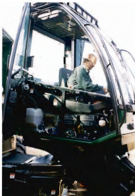
Førerkabinen set fra højre side. De to sorte bokse er minicomputerne der styrer opmålingsudstyret og maskinens funktioner.
