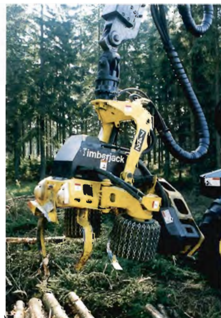
Skovningsaggregatet har 3 bevægelige og en fast kvistekniv.
