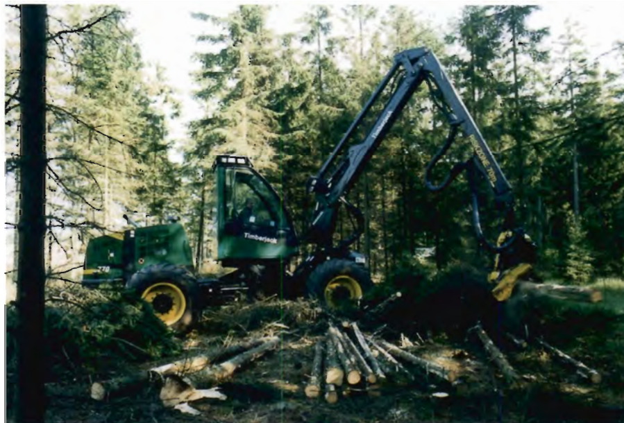
Timberjack 770 under arbejde i rødgran på 12-14 meters højde i Gludsted Plantage. Den svenske fører mente han kunne skove 120 træer i timen i denne størrelse (der er her tale om en afdrift).
