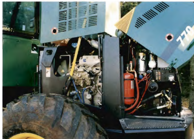
Der er let adgang til motor og hydraulikpumper.
