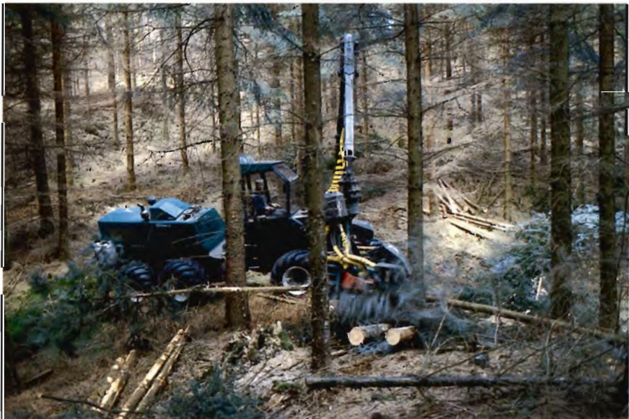
Skovningsmaskinerne er i dag i stand til at opmåle de skovede træer elektronisk. Det næste trin er at overføre disse data til et PC system og genbruge dem til klar melding, fakturering mv. (Foto viser en Silvatec 856 TH på temadagen om maskinanvendelse. Den foretager afkvisning fra toppen af træer som er fældet motormanuelt fordi maskinen ikke kunne nå dem fra sporet).
