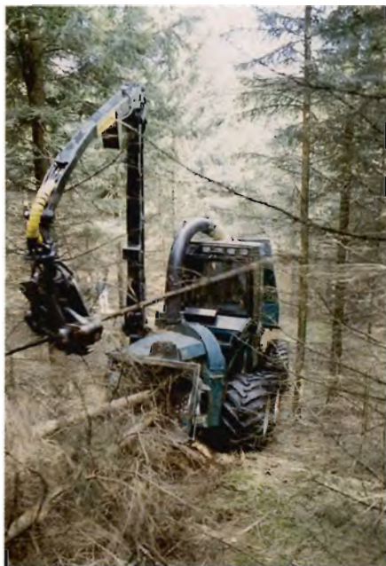
På flisområdet har Hedeselskabet flere projekter i gang. Dels effektivisering af de nuværende processer, dels produktion af flis i hugster hvor hovedproduktet er tømmer. (Foto viser en Silvatec CH 878 under flishugning i en førstegangstydning på temadagen om maskinanvendelse).
