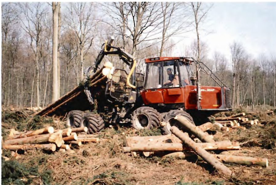
Miljøkravene indebærer bl. a. at skovmaskinerne der arbejder i statsskovene skal benytte biologisk nedbrydelige hydraulikolier, katalysator på udstødningssystemet samt - som vist på billedet - brede lavprofil dæk til sænkning af marktrykket.
