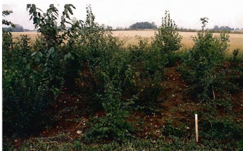
Figur 3-6. Forsøg med plantning på komprimeret jord. Figur 3: Jorden er grubbet i 60 cm dybde med 60 cm afstand mellem grubbersporene. Figur 4: Jorden er gennemgravet med rendegraver, skovlbredde 40-60 cm ned til 70 cm dybde; skovlen blev presset ned, fyldt, løftet og jorden lagt tilbage. Figur 5: Jorden er komprimeret, men ikke behandlet. Figur 6: Jorden er ikke komprimeret forud. På alle parceller er jorden fræset i 10 cm dybde af hensyn til maskinel plantning. Der er plantet eg, ask, lan- devejspoppel, hæg, tjørn og bærmispel ( Cotoneaster lucidus ).
