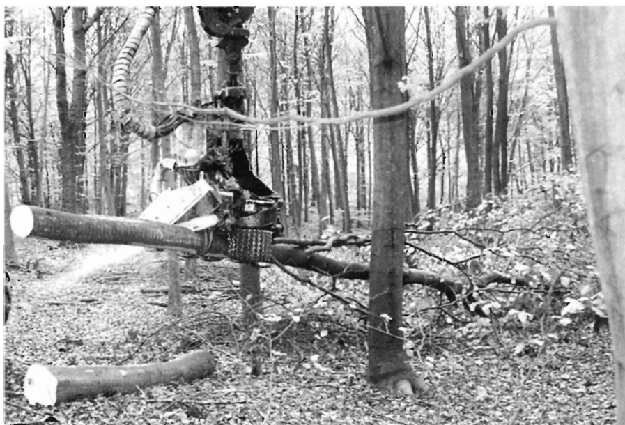
Fig. 1. Oparbejdning af et bøgetræ med DBH ca. 30 cm med FMG 250/746 Super Eva.
