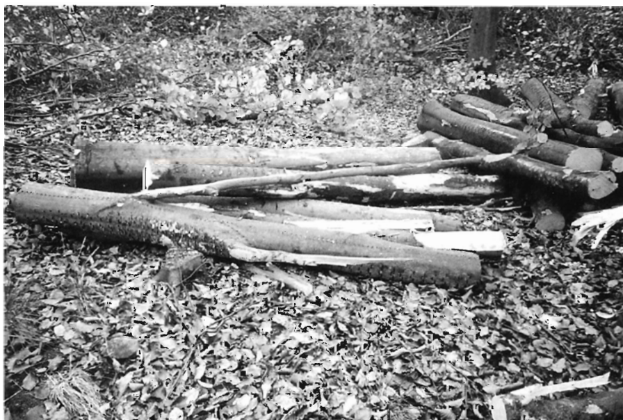
Fig. 2. Eksempler på dårlig afkvistning i en bøgebevoksning på 52 år. De meget spidse grenvinkler får kvisteknivene til at glide ovenpå grenen i stedet for at skære igennem den.
