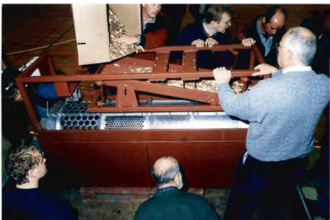
Foto 5-6. Fordelingen af partikler i en flisprøve måles normalt i et rystesold - flere skuffer oven på hinanden med stadigt finere huller. Efter 4 minutter måles mængden af flis i de forskellige skuffer. Ulemperne er bl.a. at meget grov flis ikke kan måles, nogle partikler falder længere ned end de burde, stikkere frasorteres ikke - og så er maskinen både støjende og tidrøvende. På mødet blev præsenteret en helt ny og meget enklere maskine. Den har en tromle som hælder svagt og roterer langsomt. Flisen kommer ind i den ende med de fineste huller og falder efterhånden ned i skuffer under maskinen. Det er hurtigere, næsten lydløst og giver et mere sikkert resultat.
