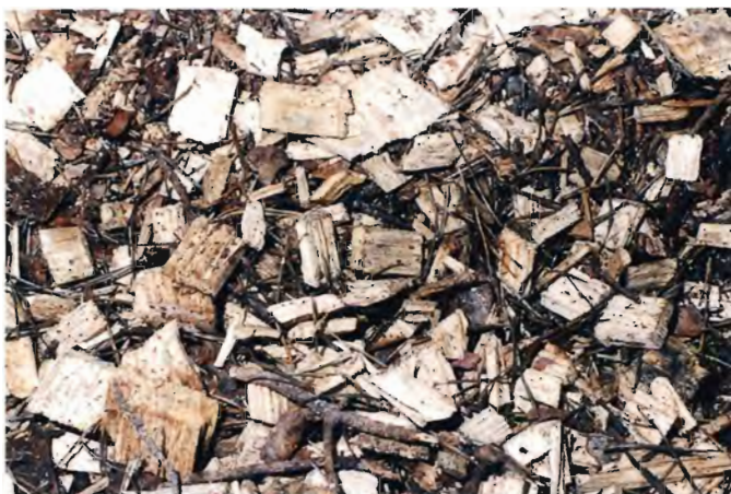
Foto 3-4. Flis hugget af en Silvatec med knivstilling 20 mm tv. og knivstilling 33 mm th.
