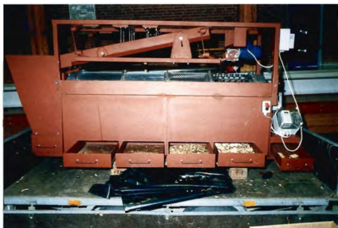
Foto 5-6. Fordelingen af partikler i en flisprøve måles normalt i et rystesold - flere skuffer oven på hinanden med stadigt finere huller. Efter 4 minutter måles mængden af flis i de forskellige skuffer. Ulemperne er bl.a. at meget grov flis ikke kan måles, nogle partikler falder længere ned end de burde, stikkere frasorteres ikke - og så er maskinen både støjende og tidrøvende. På mødet blev præsenteret en helt ny og meget enklere maskine. Den har en tromle som hælder svagt og roterer langsomt. Flisen kommer ind i den ende med de fineste huller og falder efterhånden ned i skuffer under maskinen. Det er hurtigere, næsten lydløst og giver et mere sikkert resultat.
