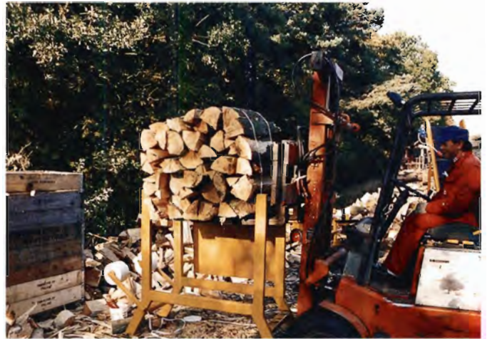
Brændet stables i en jernramme der kan rumme 1 rm og snøres derefter sammen med plasticstrips.
