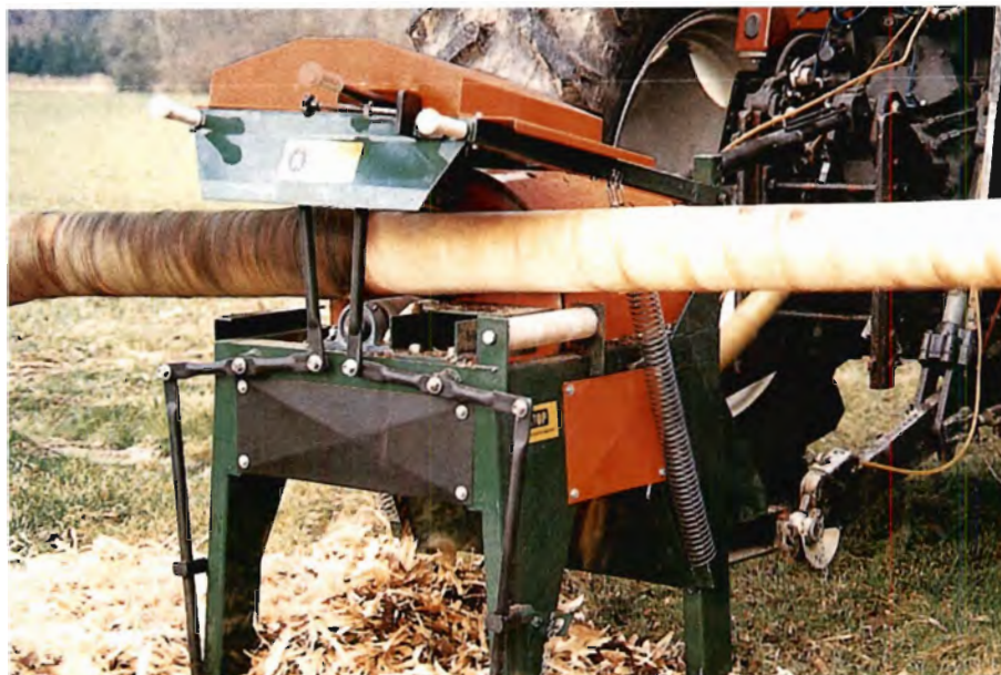
Pælemaskinen leveres med trepunktsophæng og kan afbarke og tilspidse pælene.
