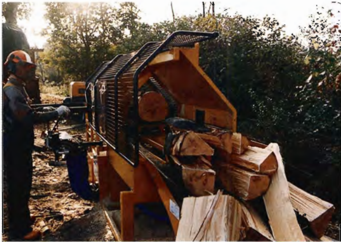
Stammen afkortes først med en kædesav, hvorefter et stempel presser træet mod kløvejernet der kløver træet i op til 6 dele.
