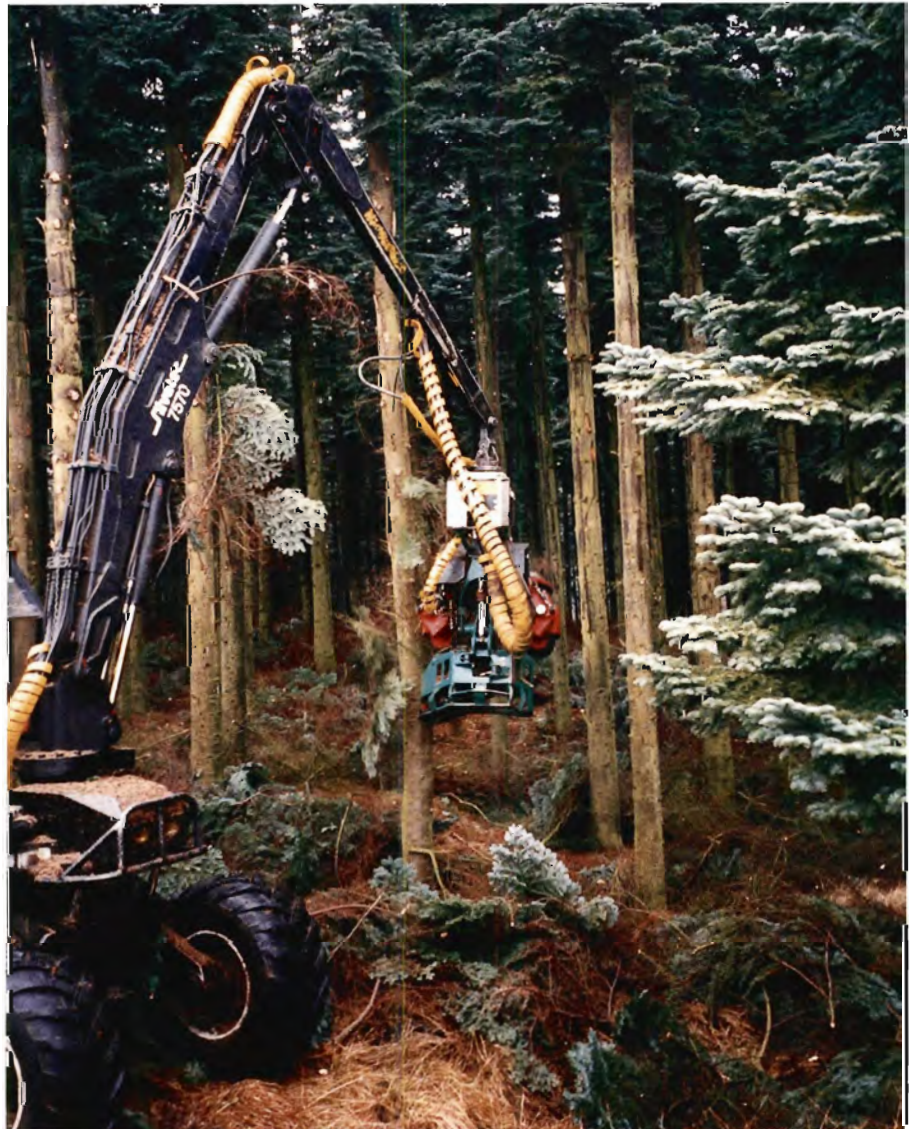
Opstamningen foretages med et ombygget skovningsaggregat, men med andre knive, afstandsruller og maderuller.
