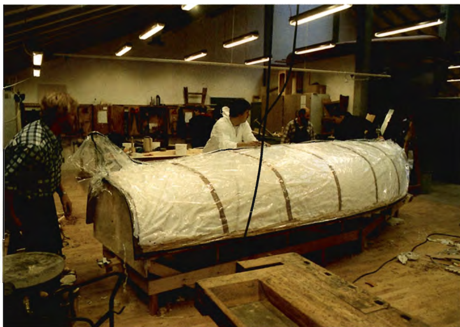
Der er nu sat vacuum på, og fineren presses sammen under et tryk på -0,6 bar, svarende til 0,6 kg/cm 2 .
