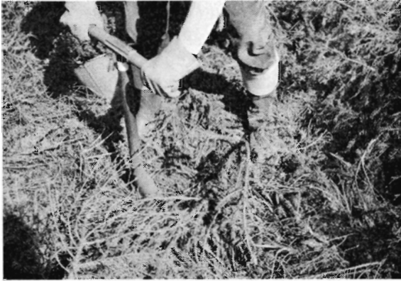
Fig. 2: Boret tvinges i jorden, man udnytter kroppens vægt ved at gå ned i knæene. Boret drejes om sin akse, således at jordproppen skæres fri.
