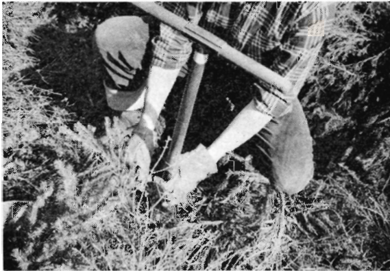
Fig. 2: Boret tvinges i jorden, man udnytter kroppens vægt ved at gå ned i knæene. Boret drejes om sin akse, således at jordproppen skæres fri.
