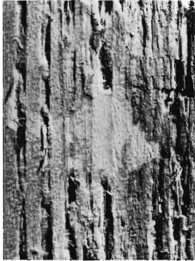
Fig. 8. Detalje fra fig. 7 visende lys plet med tæt mycel og den kamrede ødelæggelse (x 3,2).
