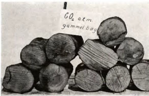
Fig. 4. Bøgetræ, der efter 6 måneders henstand i skoven er anbragt i plastiksæk (PVC) med kuldioxid og 100 % luftfugtighed og opbevaret her i 3 måneder. De få og små mycelbelægninger skyldes ikke-veddestruerende svampe.
