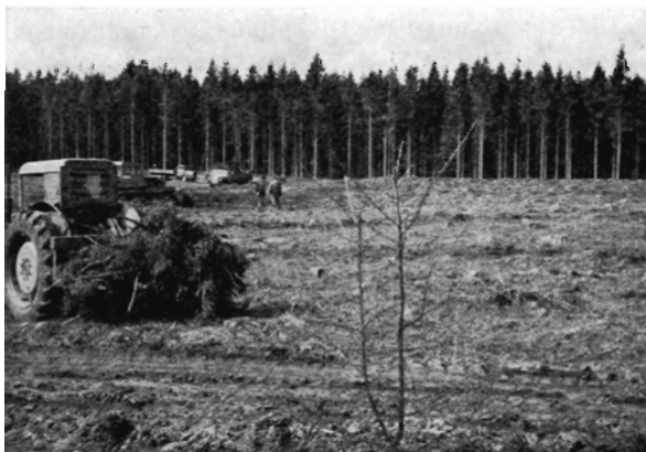
Fig. 1. Hastrup bagskubber under kvassamlingen i parcel II i Gludsted plantage.
