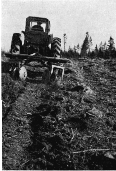
Fig. 7. Lindborg-spadeharve i arbejde i et stødfrit mellemrum, hvor der tidligere har stået en række bjergfy. Parcel II Gludsted plantage.
