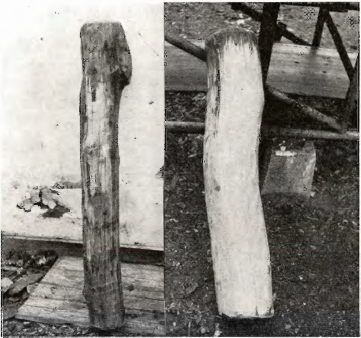
Fig. 3. Bøg afbarket fuldstændigt i Cambio- og tromlebarker. Bemærk de afrundede kanter. Broby.
