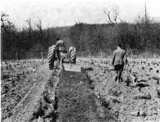
Fig. 2. Howard Rotavator typ. PMO 40 ved rensningsarbejde. (Billedet skal kun illustrere princippet).
