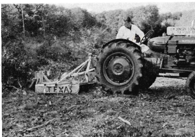
Fig. 11. Grenknuseren i arbejde, bemærk opvæksten og kvaset på skovbunden.
