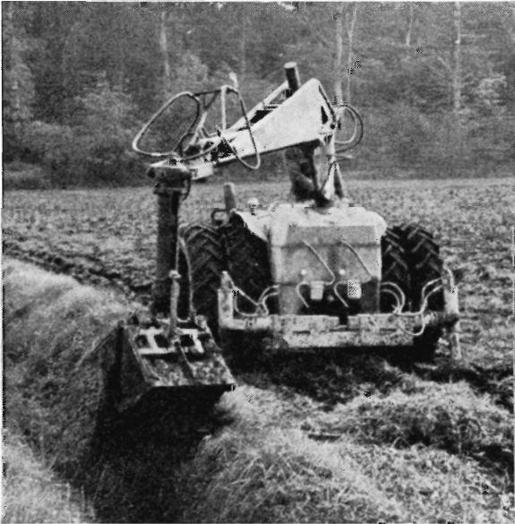
Fig. 12. Salta 602 ved oprensingsarbejde på Gråsten distrikt.
