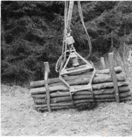
Fig. 22. Den hydrauliske grab omslutter her ca. 1,5 rm. (tometertræ) (indsvejet for enmetertræ.)
