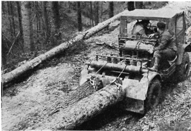
Fig. 19. Unimogtraktor ved udslæbning v.h.a. Gloggerspillet bemærk også beskyttelsesskjold og specialkroge for beskyttelse af wiren mod slid.
