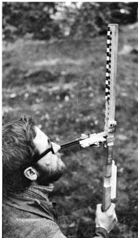
Fig. 3. Instrumentet anvendt som højdemåler. Ud for øjet ses den forskydelige stang, og lige over hængslet sidder en libelle med spejl.
