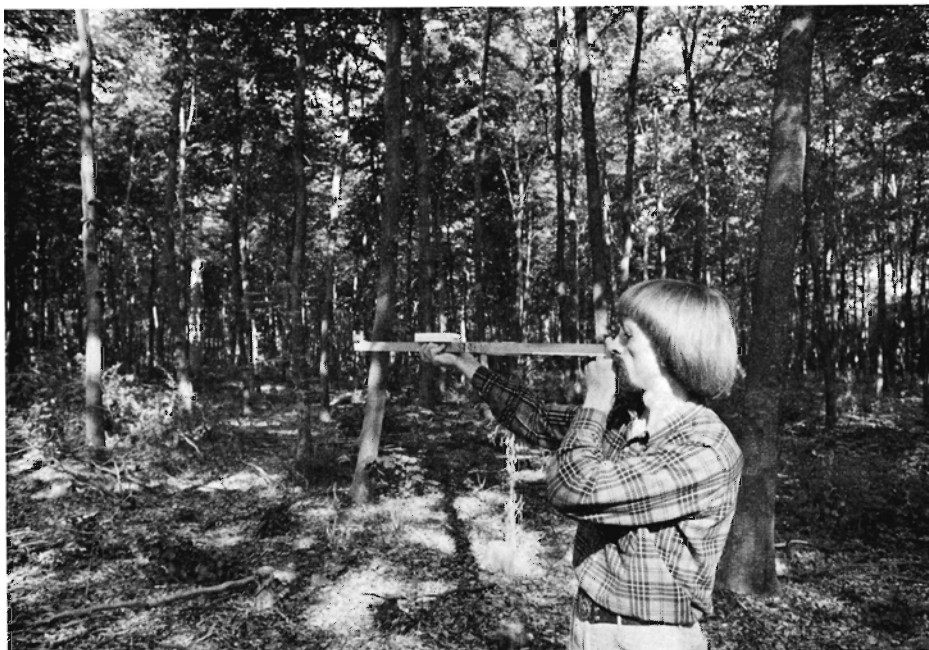
Fig. 1. Instrumentet anvendt som stangrelaskop. Over højre hånd ses tællerværket.
