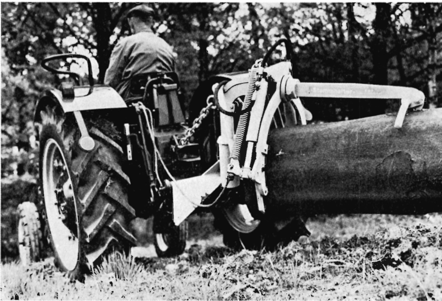
Figur 1: Landbrugstraktor med hydraulisk udslæbningsaks: Kuxmann Stammhalter Model II
