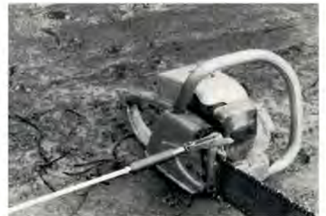
Beslaget er konstrueret således, at stangen kan anbringes i den for arbejdet mest hensigtsmæssige stilling.
