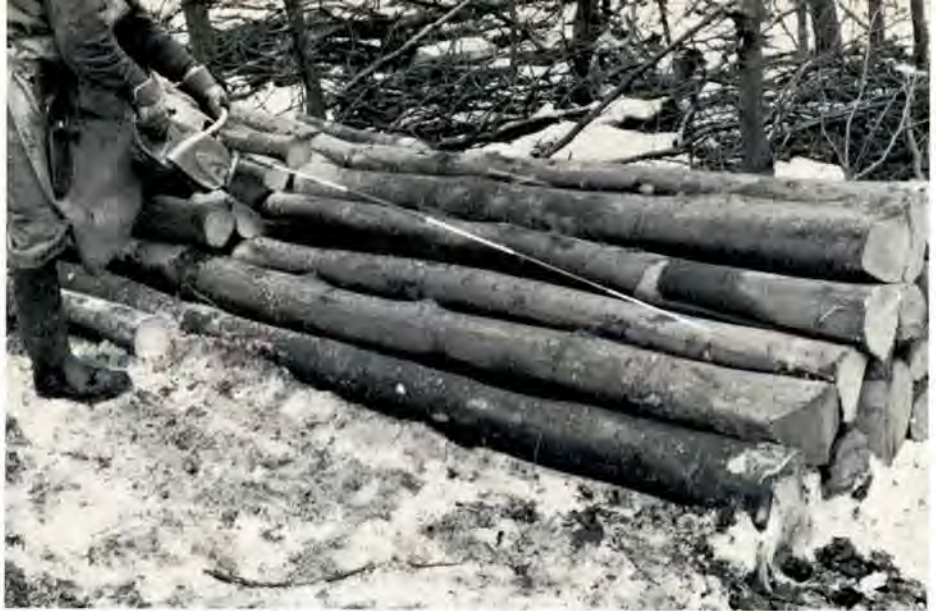
Målestang, der med fordel kan anvendes ved afkortning af ungt træ efter udslibning.
