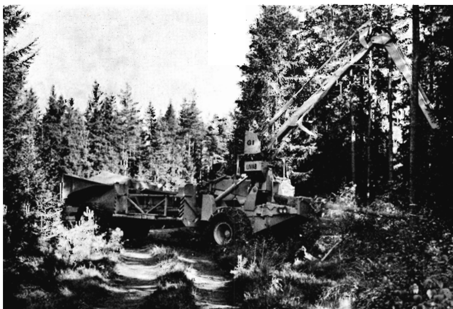
Fig. 2: Livab G 1 under fældning, afkvistning, afkortning og sortering.
