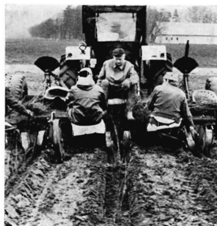
Figur 1. Hedeselskabets læplantningsarbejder i Vendsyssel har konstrueret en 3-furet plantemaskine, som er velegnet til plantning af 3-rækkede læhegn. Den er komponeret af tre enkeltfurede Toineplantemaskiner. Fuldt bemanded kan maskinen i en 8 timers arbejdsdag plante 8 km 3-rækkede læhegn med i alt 24.000 planter. Det er 3 gange flere, end der kan plantes manuelt. Herudover sikrer maskinplantningen lettere renholdelse af planterne og mindst mulig udtørring, når plantningen udføres i én arbejdsdag.
