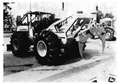
Fig. 6. Amerikansk John Deere udslæbningstraktor med hydraulisk saks. Udstyr af denne art vinder i øjeblikket stærkt frem i USA og Canada og vil i løbet af få år givetvis også få indpas hos os.
