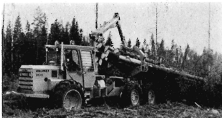
Fig. 3. Stor udslæbningstraktor med klembanke.
