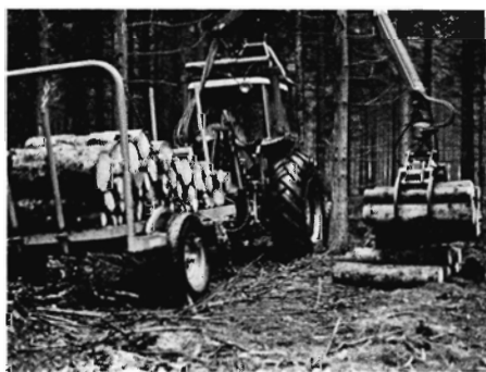
Figur 3. På Hedeselskabets 6. plantage-distrikt benyttes en forbedret CN skovvogn til udbringning af rummetertræ. Effekterne læsses med den tagmonterede hydrauliske kran, og ved fast vej kan en øvet traktorfører tippe læsset, så stabling med håndkraft undgås.
