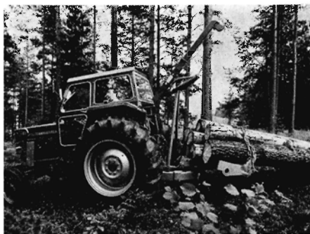
Fig. 6. Let finsk klembanke-løsning til læsning med wirekran.
