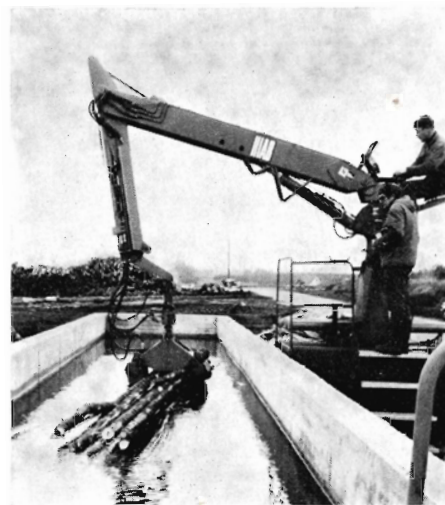
Figur 1: Novopan Træindustri A/S bestemmer rumvægten på tusindvis af partier af langt spånpladetræ i kg pr. m 3 sand masse ved vejning over og under vand. Disse oplysninger indsamles og analyseres af Novopan, Skovteknisk Institut og Forskningsstiftelsen Skogsarbeten.
