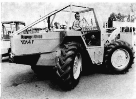
Fig. 4. Kramer Allrad 1014 ses i skovversion. Traktoren er interessant ved at have dobbeltmanøvrering, hvilket muliggør arbejde i begge retninger. Bemærk også firehjulsstyringen der holder vendediameteren under 8 m.
