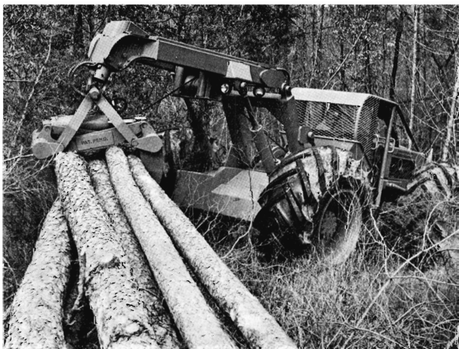
Fig. 2. Stor udslæbningstraktor med grab.
