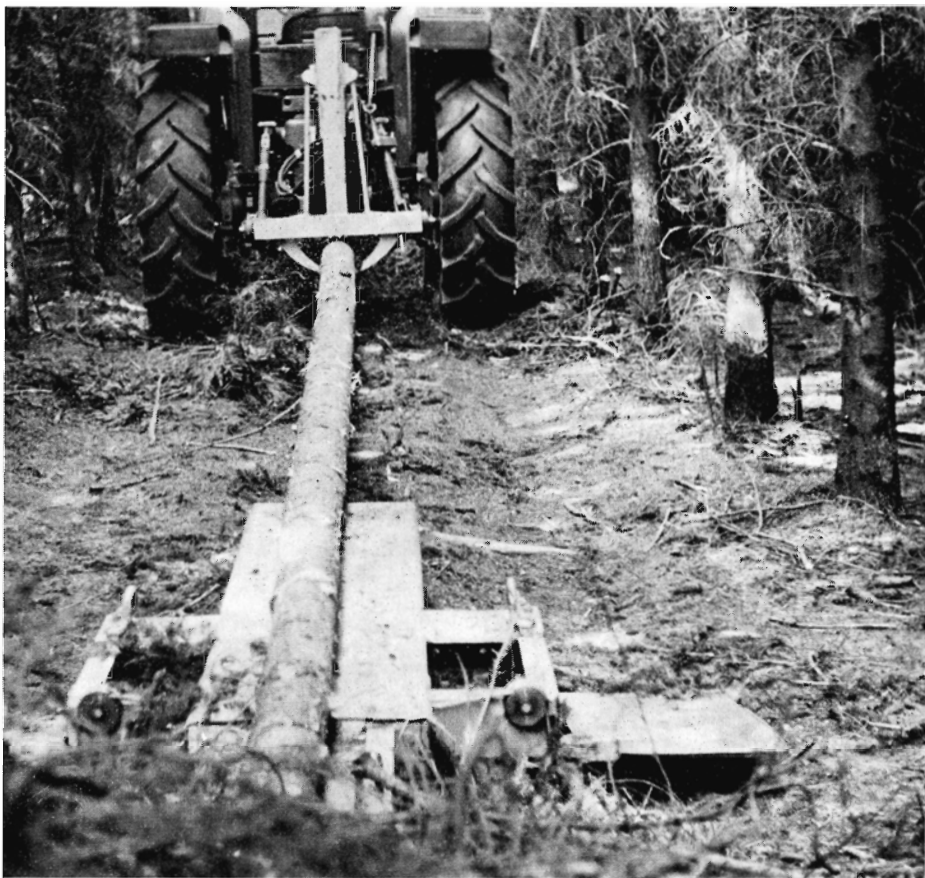
Skovteknisk Instituts afkvistningssystem bygger på enkle og robuste tekniske løsninger med et lavt investeringsniveau. Det tekniske udstyr består af en traktor med hydraulisk saks og et afkvistningsaggregat. Det vises som forsøgsmodel på Maskindemonstrationen den 19. september.
