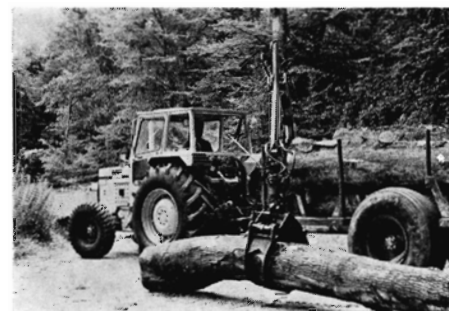
Figur 1. MF 50 TC (industritraktor) med momentomformer og hydraulisk vendegear bruges på Jægersborg statsskovdistrikt sammen med Häglingevoغن til udkørsel af alle afkortede effekter.
