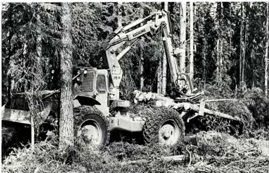
FIG. 3: Fældning og bunkelægning med fælder-bundter.
