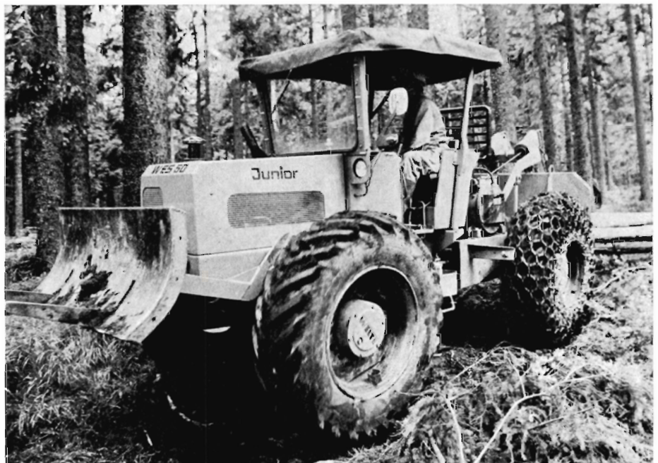
Den tyske skovtraktor WELTE blev vist i to udgaver. Her er den mindste med en 4 cyl. motor og 64 HK. Den er forsynet med totromlet hydraulisk spil. Prisen er ca. 120.000 kr.
