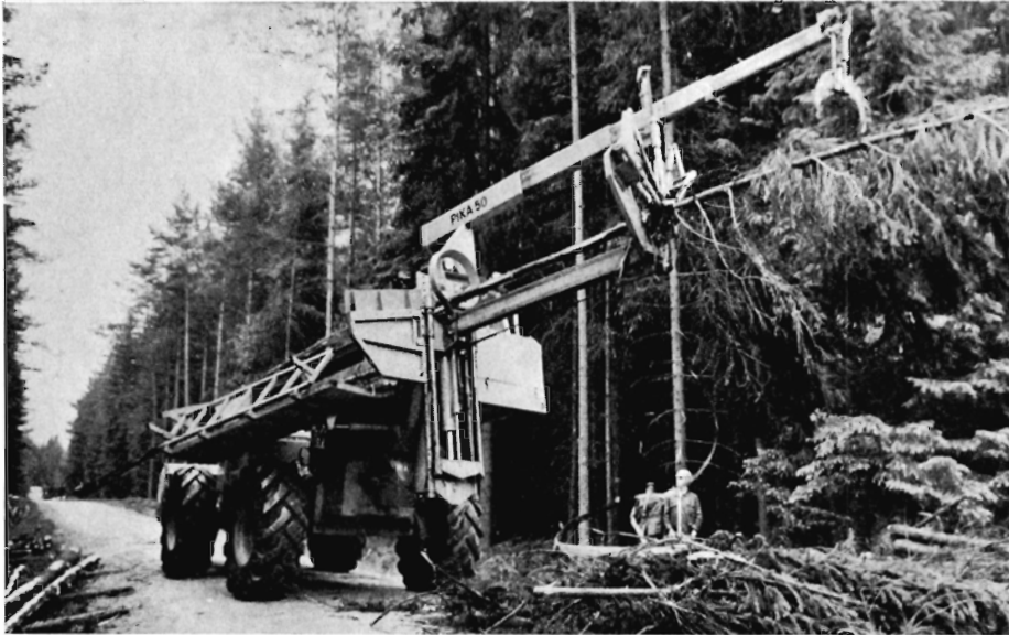
Den finske afkvistningsmaskine PIKA 50 blev vist i et skovnings- og transportsystem for gennemhugning, hvor fældningen blev foretaget maskinelt med hydrauliske fældeskær. Træerne blev transporteret med kviste på til bilvej, hvor så afkvistningen med PIKA 50 foregik.
