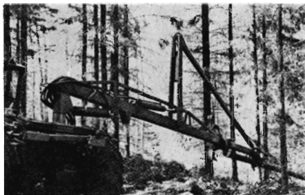
2. Stegmateren kan afkviste træer fra stiksporsmellemrummene. Det er muligt, at Kochums kommer til at producere og forhandle maskinen.
