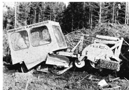
Plantningssystemet udfører kvasrydning, jordbearbejdning og plantning.
