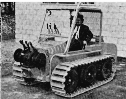
9. Variotrac. Let norsk bæltetraktor. 28 hk, bredde 1,7 m, vægt 1700 kg. Iglandspil model kompakt med to tromler, pris ca. kr. 65.000 incl. spil og skjold.
