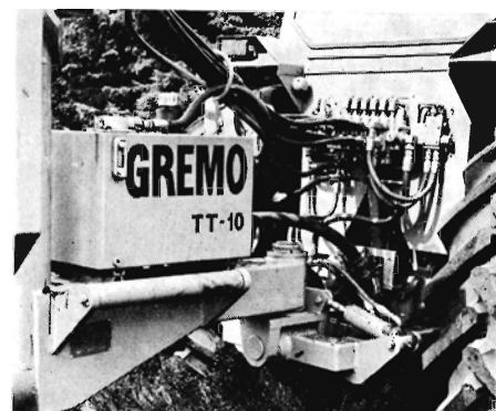
Fig. 2. For at opnå de ønskede egenskaber var det nødvendigt at konstruere et helt nyt trækstøj til Gremo TT 10. Sammenlignet med en almindelig trækrog giver den nye konstruktion flere væsentlige fordele, således bedre traktorstabilitet ved stor vægtoverførelse fra vognen, bedre manøvrevevne og ikke mindst mulighed for en hurtig og effektiv stabilisering af den vognmonterede kran.
