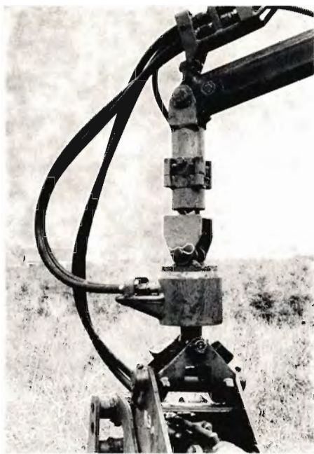
Fig. 3. Den ene af Hydrovågs to hovedkomponenter »føleren« placeres mellem kranarmen og grabben; den anden »viserinstrumentet« placeres i traktorens førerhus.
