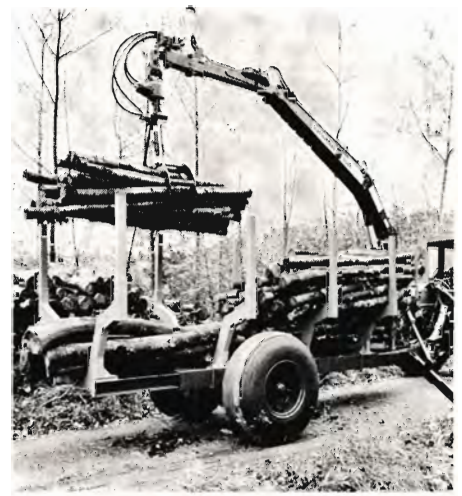
FIG. 4. Kjulerupvognen i 7 t udgave. Bemærk forlænger og det alternative monteringssted for vognakslen bagest på den faste del af chassiset. Den, der kender Kjulerupvognen fra tidligere, vil også bemærke den nye langt stærkere opbygning af kæpstokkene.
