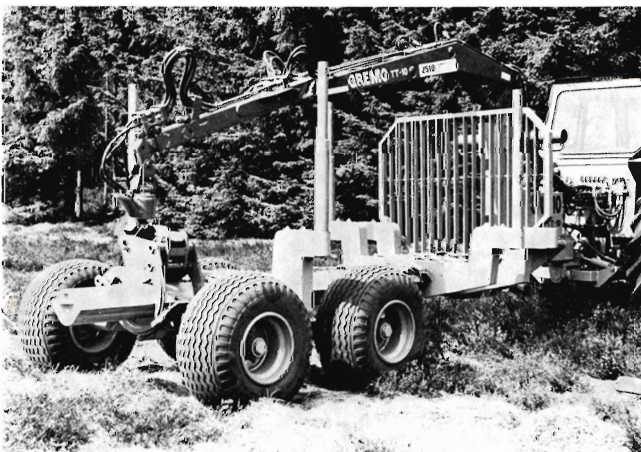
Fig. 1. Gremo TT 10 er en ny 10 t bogievogn fra maskinfabrikken Gremo. Vognen er opbygget over et kraftigt centralrør, hvorpå såvel hjul som kæpstokke og gitter kan forskydes.
