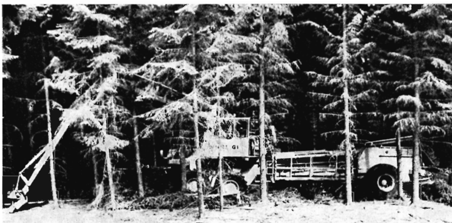
Den første svenske flerproces-maskine, bygget for tyndingsbevoksninger, blev præsenteret på Elmia. Maskinen, der er en forsøgsmodel med betegnelsen Livab G1, er udviklet af Lihnell Vagn AB.
