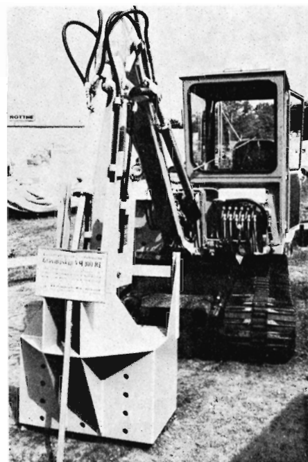
Let gravemaskine, der synes velegnet til grøftning i skoven. Skovteknisk Institut søger at få den til landet for afprøvning.
