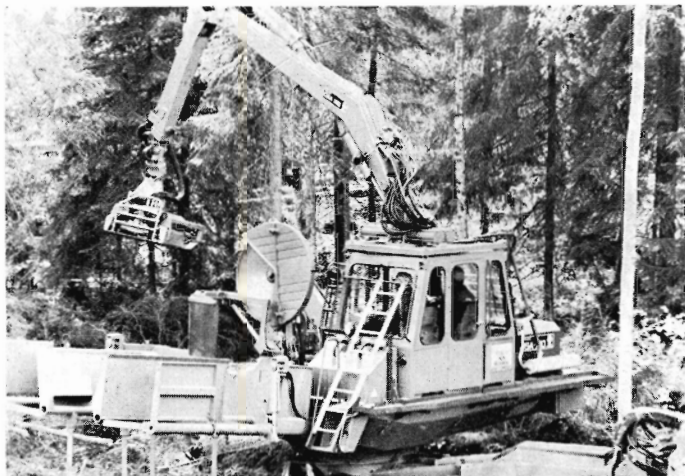
Skovbrugets mejetærsker her i ÖSA's udgave. Maskinen fælder, kvister, afkorter, sorterer og bunkelægger effekterne. Totalvægt: 23 tons.
