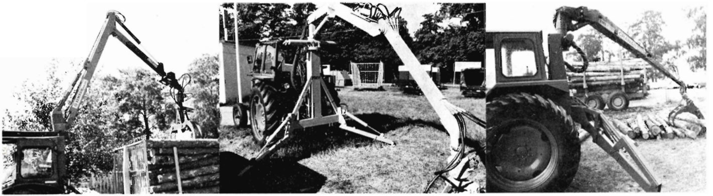
De moderne gummiophængte traktorførerhuse har givet fabrikanterne af traktormonterede kraner alvorlige problemer. - Her ses tre forskellige løsninger: Simson kranen på en ramme anbragt over førerhuset, F.M.V. kranen i liftmonteret udgave og Cranab SK 2500 monteret på lynkoblingsramme.
