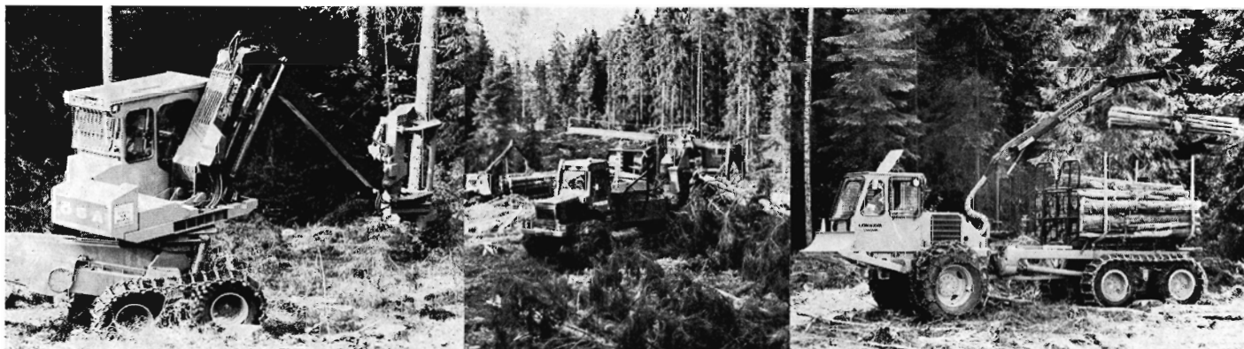
I det svenske system for den højmekaniserede sortimentsmetode indgår tre maskiner: En fælder-lægger anbringer træerne i bunker, processoren afkvister, afkorter og placerer træet i sorterede bunker for den efterfølgende udtransport med en storskoter.
