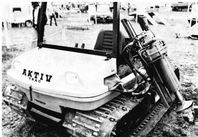
Udstyr til plantning af pottede planter monteret på et let bæltekøretøj - Aktiv Trac.
