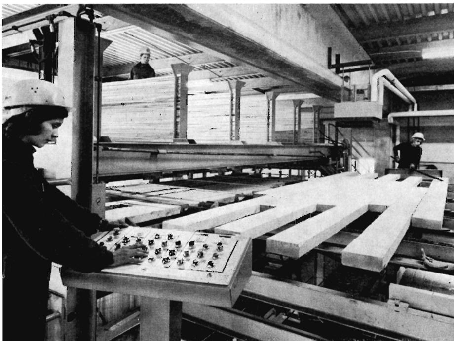
Strøtlægningsmaskine, der indlægger strøer inden træet tørres.
