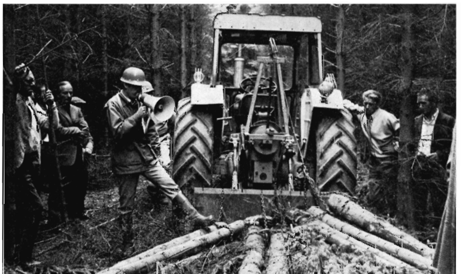
Konsulent E. Leer forklarer udlæbning med traktor i faldende længder med JoBu-handy spil og udlæbningsskjold til fæstning af kæderne med stammerne.
