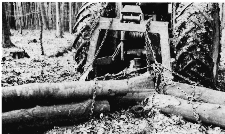
Indslevspillet med to gear er velegnet også til udslæbning af små kævler (her 5,4 m gulvtræ). Den benyttede kævlebue mangler lodrette wireruller — dette bevirker et unødvendigt stort wireslid
