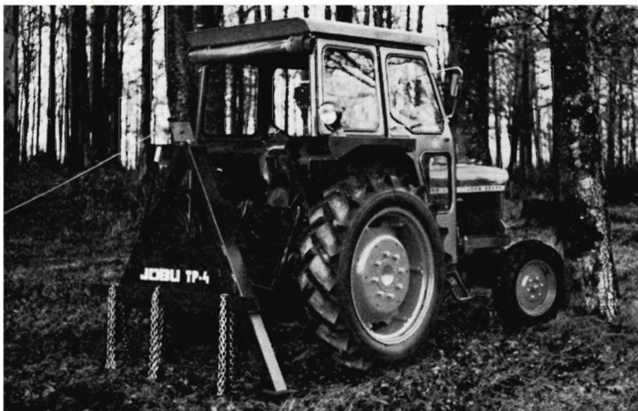
Det liftmonterede udslæbningsspil Jobu-TP-4 er forsynet med ben, der støtter mod jorden under indspilningen. På de spil, der sælges i Danmark, er benene tillige udformede som stablesko
