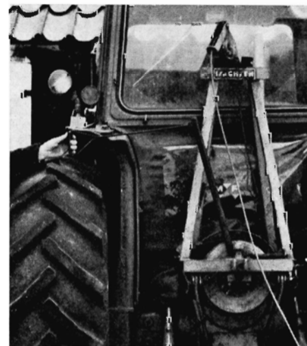
Ændret koblingshåndtag på Jobu-Handy. Med det nye håndtag behøver føreren ikke træde ind bag traktoren under indspilningen
