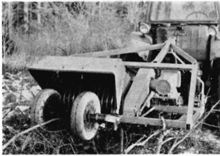
Smal version af den svære Ugerløse grenknuser. Arbejdsbredde ca. 50 cm.
