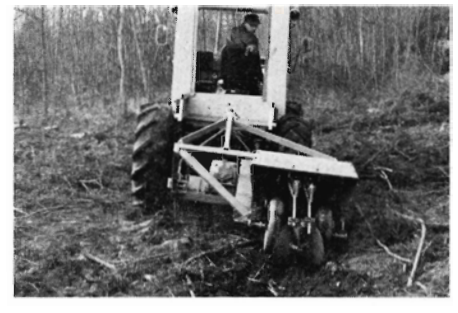
Knusning og overfladisk jordbearbejdning i en arbejdsgang.
