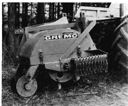
Kvasknuseren fra Grenå Maskinfabrik frembringer en ca. 30 cm bred kvaskfri stribe.
