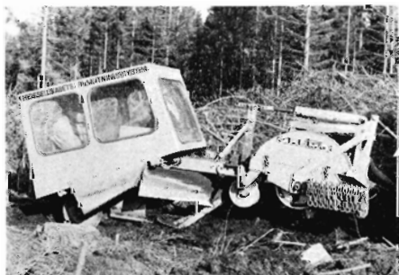
Plantningssystemet udfører kvasknusing, jordbearbejdning og plantning.
