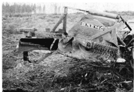
Kvasknuseren kombineret med dobbeltplow og grubber.
