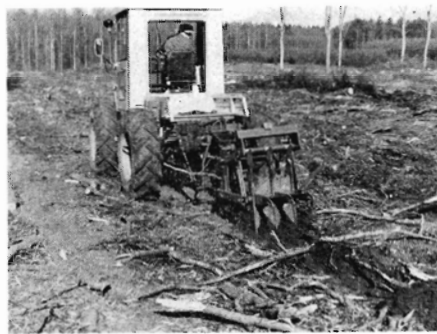
Kulla kultivatoren afskræller humuslaget i felter på ca. 50x60 cm. Kultivatoren ruller over forhindringer.
