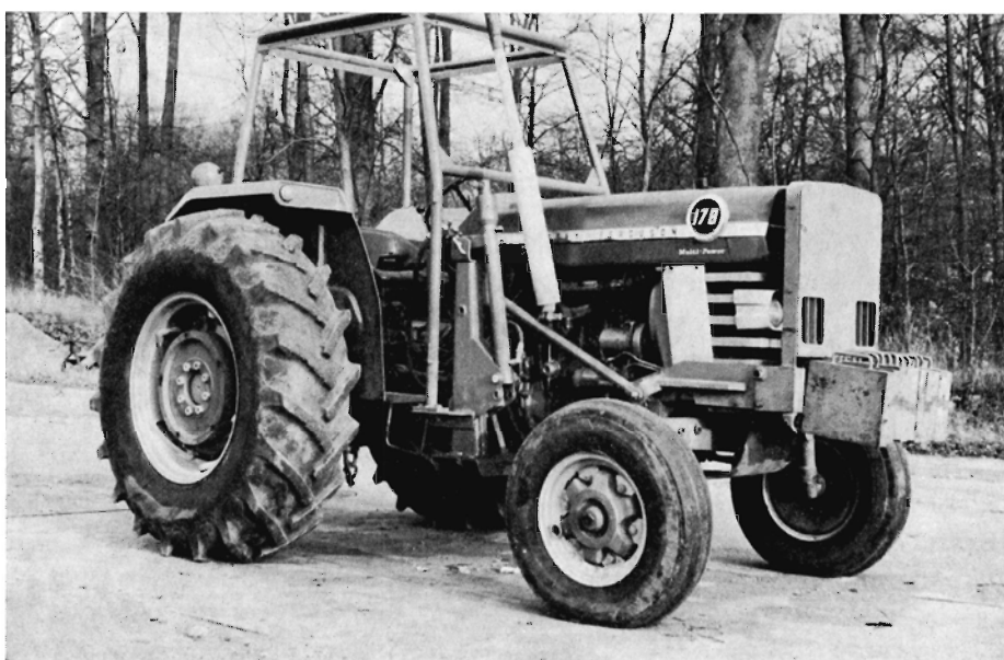
Landbrugstraktoren vil endnu i en del år udgøre en væsentlig part af skovbrugets kraftmaskiner. Variationerne i dens virkningsgrad og hele udnyttelse skyldes som regel manglende hjulgreb på grund af utilstrækkelig vægt på drivhjulene, mindre egnede dæk- og hjuludrustning og manglende kendskab til disse forhold. Billedet viser en landbrugstraktor udstyret som udslebningstraktor med stærk hensyntagen til hjul- og dækudstyret, traktorens afskærmning, længdestabilitet og trækkrogs-effekt ved anvendelse af variable frontvægte m.v.
