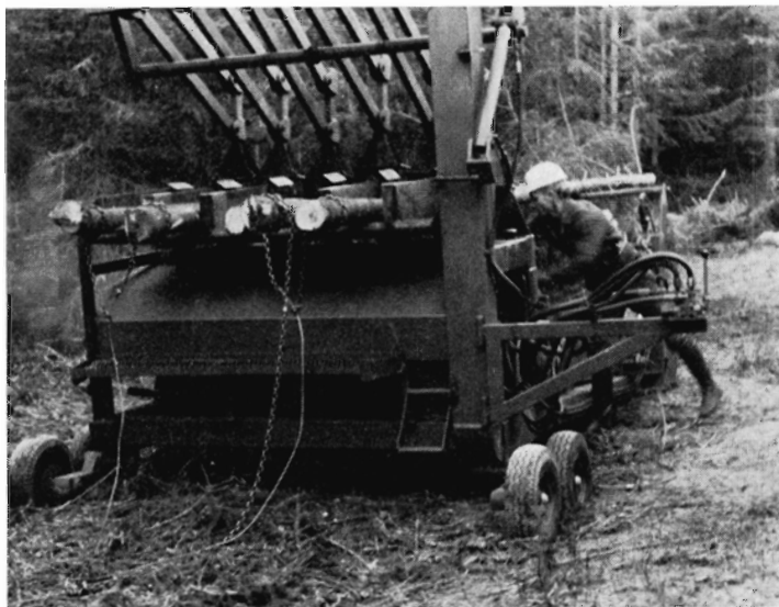
Det norske Skogforsøksvesens kvistningsmaskine for tyndingsbevoksninger. Desværre er præstationen ikke stor nok til at gøre den rentabel.
