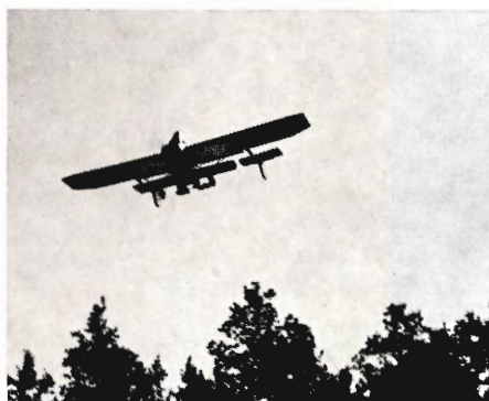
Fig. 1. Air-trucken på vingerne. Bemærk de brede vinger og at maskinen er meget kort.
